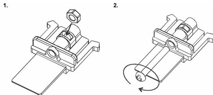
طرز اتصال سیم به ترانس جریان CT (در صورت انتخاب استفاده از CT)
