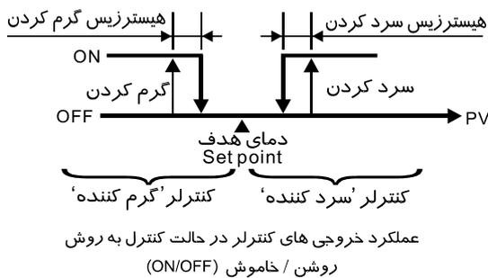
عملکرد خروجی های کنترلر در حالت کنترلر به روش روشن / خاموش (ON/OFF)
